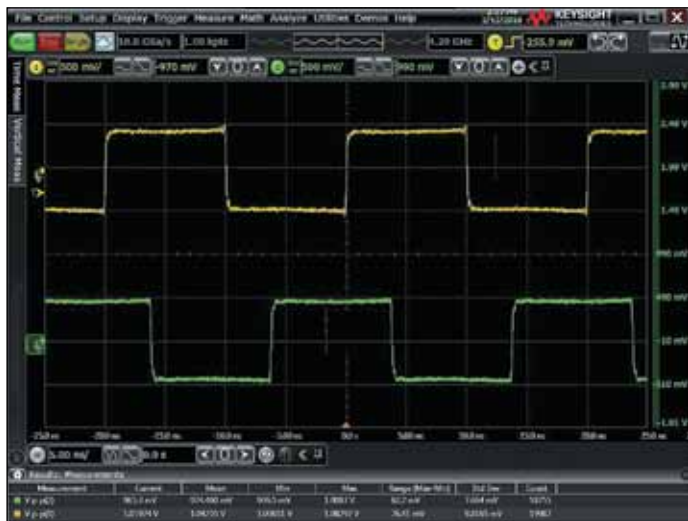
Рис. 3. Выходной сигнал генератора и сигнал пробника
