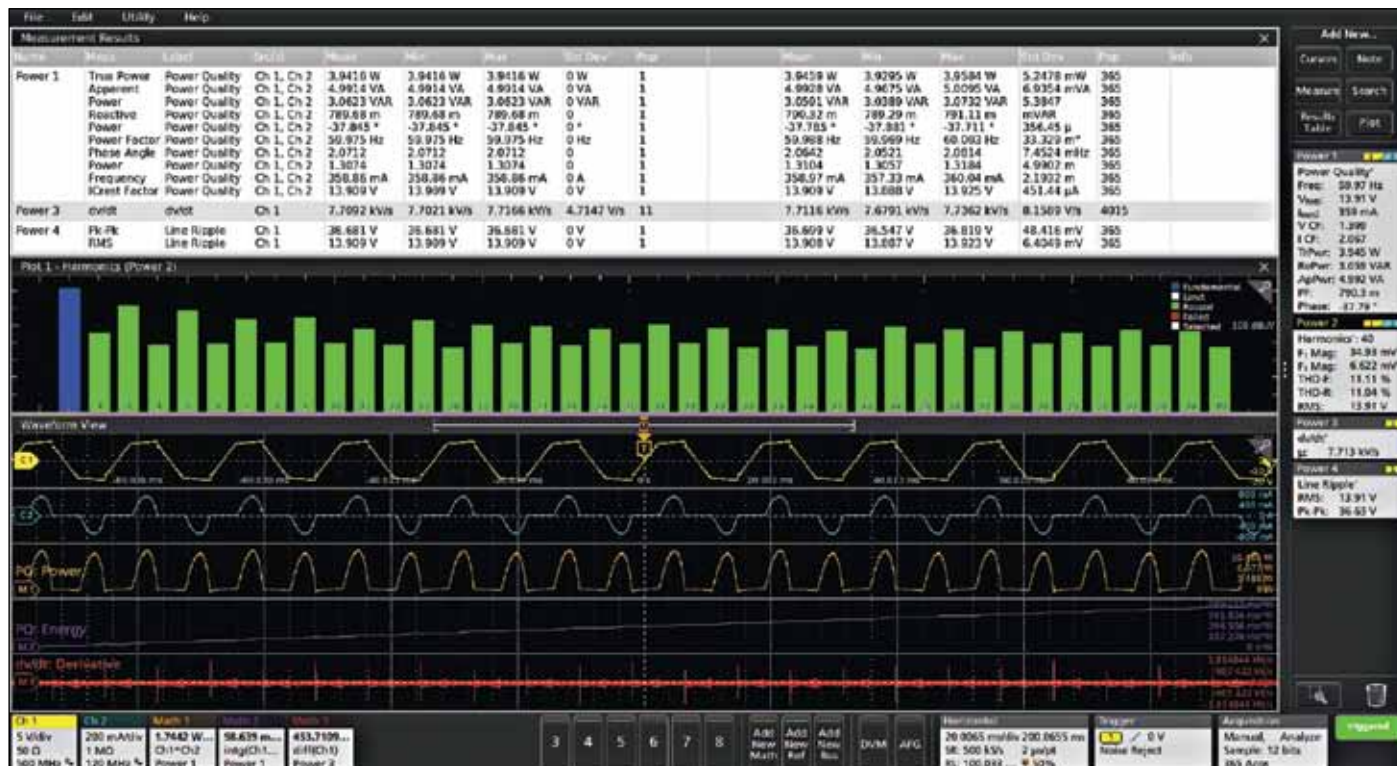
Рис. 11. Вид окна MSO58 при измерении параметров мощности
