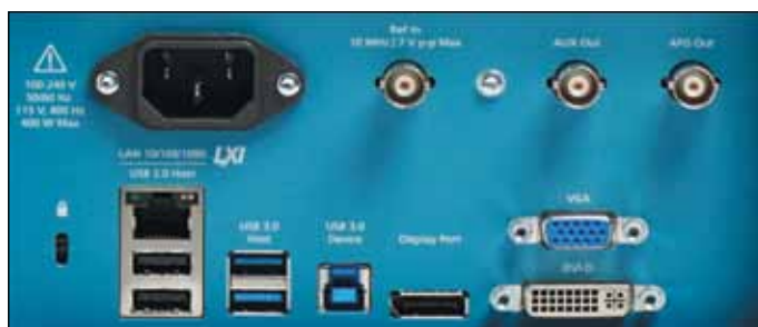
Рис. 12. Расположение разъемов на задней панели осциллографа MSO58
