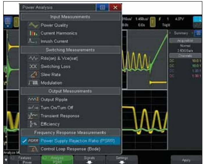
Рис. 2. Прикладная программа DSOX3PWR для измерения и анализа мощности для осциллографов серии InfiniiVision 3000X от компании Keysight Примечание. На заднем плане — напряжение на силовом ключе обратного преобразователя.
