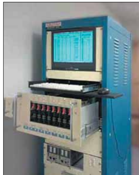
Рис. 2. Система тестирования срока службы реле Coto Technology 300
