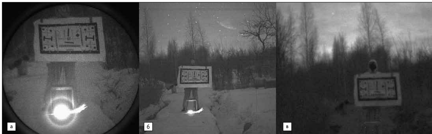
Рис. 1. Видеокдры (объекты: человек, таблица, светодиодный фонарь): а) VC249-ЭОП; б) VC400; в) VSM320
