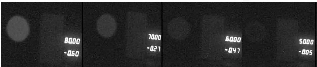
Рис. 4. Видеокадры камеры ближнего ИК-диапазона VS320 для разной температуры абсолютно черного тела
