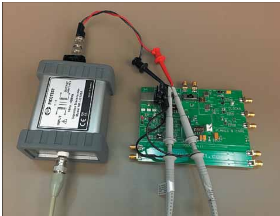
Рис. 10. Проверка контура регулирования с использованием трансформатора тока Picotest J2101A
