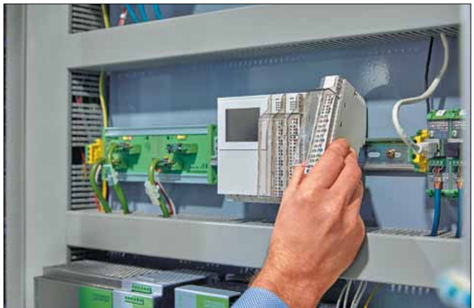
Рис. 4. Готовые модули в корпусах ME-IO могут быть извлечены из системы без разрыва соединений. Горячее подключение возможно благодаря шинному соединению разъемом TBUS на DIN-рейке
