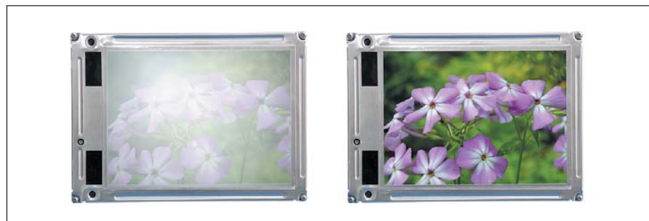
Рис. 11. Слева экран TFT-дисплея без дополнительного фильтра, справа с фильтром
