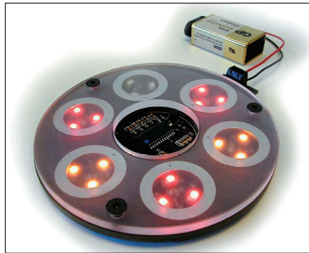
Рис. 7. Отладочная плата для сенсора QT160
