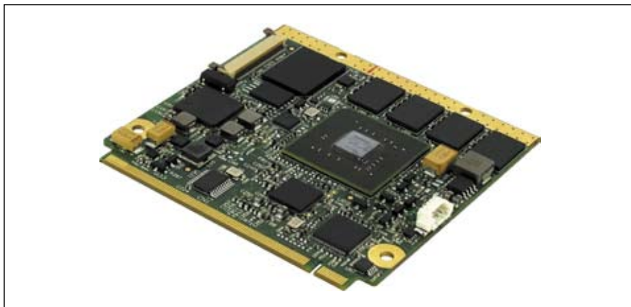
Рис. 1. Модуль SECO Qseven с процессором NVIDIA Tegra2 на ядре Cortex-A9
