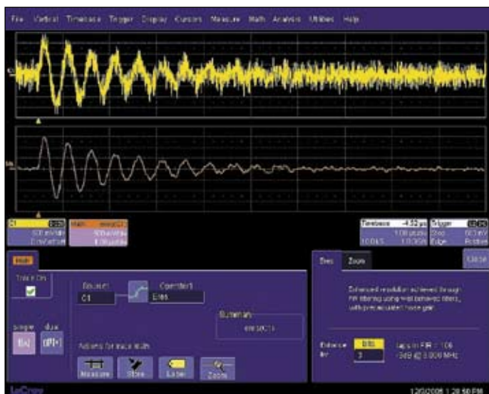
Рис. 3. Тот же сигнал, что представлен на рис. 2. Нижняя развертка представляет собой однократный сбор данных без усреднения; фильтр удаляет шум свыше 8 МГц; как реальный, являющийся частью сигнала, так и приобретенный в процессе сбора данных
