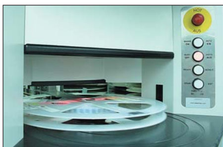
Рис. 4. Сканирование штрих-кода катушки
