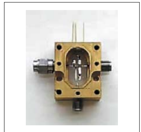
Рис. 15. 30-Гц СВЧ-блок USB стробоскопического осциллографа-приставки UDS-2022 фирмы Eltesta
