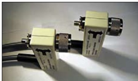
Рис. 18. СВЧ-блоки синхронизации (триггеры) фирмы Eltesta
