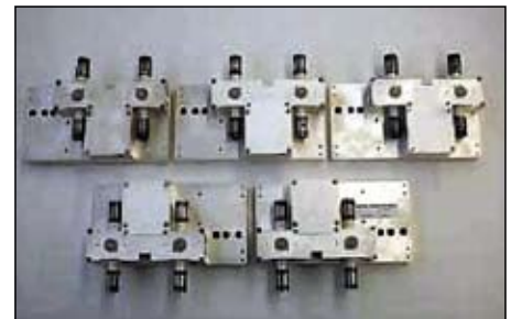
Рис. 14. СВЧ-блоки USB стробоскопического осциллографа-приставки UDS-2022 фирмы Eltesta
