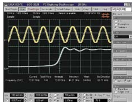
Рис. 19. Окно осциллографа UDS-2000 фирмы Eltesta с осциллограммами 14-Гц синусоиды и перепада от генератора тестовых импульсов
