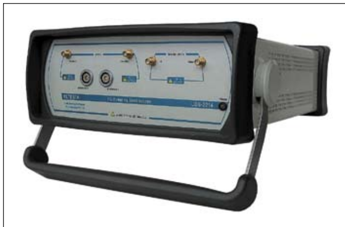
Рис. 17. Внешний вид USB стробоскопического осциллографа-приставки UDS-2214 фирмы Eltesta с возможностью TDR/TDT
