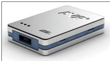
Рис. 3. Внутрисхемный эмулятор JTAGICE3
