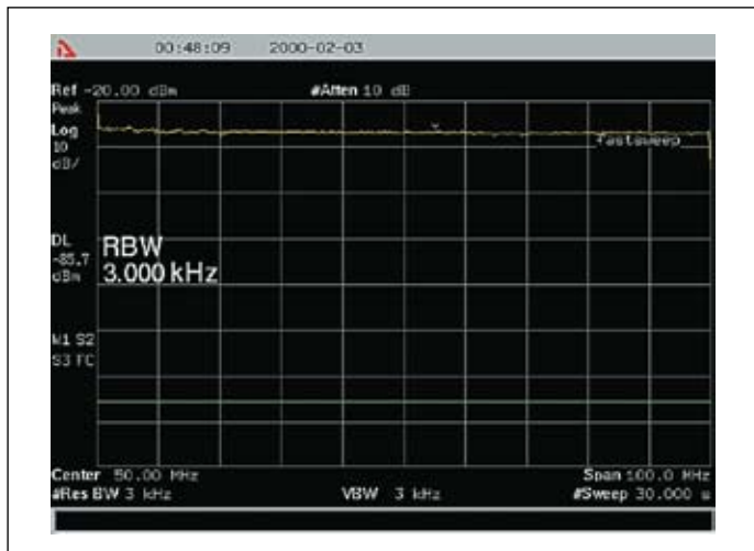
Рис. 19. Окно анализатора спектра АКС-1301 с установками для просмотра АЧХ в диапазоне от 0 до 100 МГц
