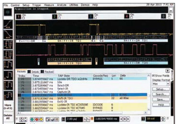
Рис. 1. Визуализация состояний TAP осциллографом Agilent Infiniium 9000
