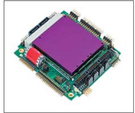
**Рис. 6.** Модуль из линейки Kontron Microspace MSM200 на базе процессора Intel Atom Z510/Z530
