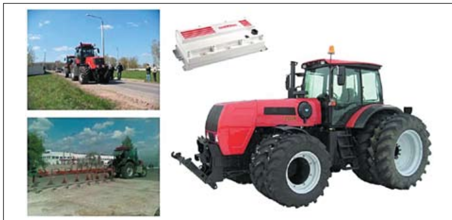
Рис. 7. Трактор 300 л. с. с электрической трансмиссией переменного тока
