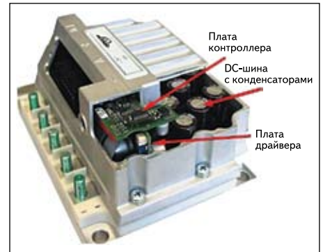
Рис. 6. Модуль привода вилчатого погрузчика серии LAC
