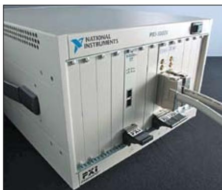
Рис. 1. Интеграция контроллера периферийного сканирования в тестовое оборудование от National Instruments
