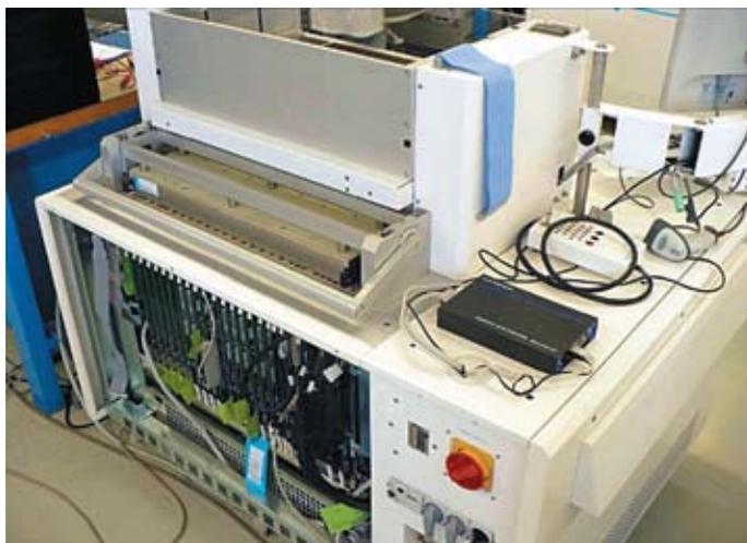
Рис. 2. Интеграция периферийного сканирования JTAG в установку внутрисхемного теста SPEA 3030 (справа установлен JTAG-контроллер, имеющий интерфейс с тестером)
