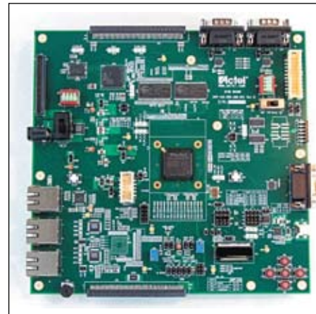
Рис. 5. Плата из набора SmartFusionDevelopmentKi
