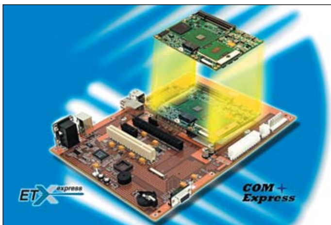
Рис. 1. Стандартизованный модуль COM устанавливается на специализированную базовую плату, где реализуются дополнительные компоненты и физические интерфейсы
