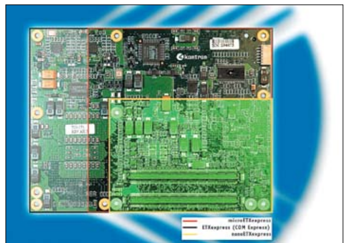
Рис. 2. Габариты модулей COM Express, microETXexpress и nanoETXexpress
