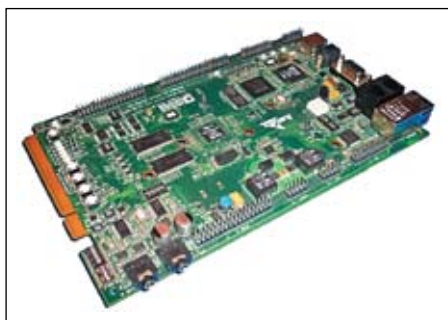
Рис. 1. Отладочная плата ADSP-BF537 EZ-KIT LITE
