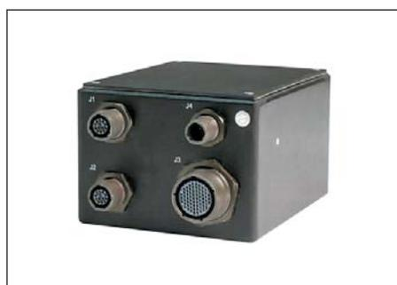
Рис. 2. Защищенный 5-портовый коммутатор Ethernet DuraNet 1059 для транспорта и авиации
