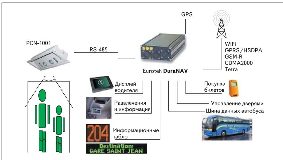
Рис. 6. Система управления автобусом на базе модуля DuraNAV
