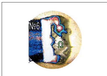
Рис. 10. Внешний вид некачественного микросварного соединения № 6 и соответствующая ему лазерная фотоакустическая топограмма
