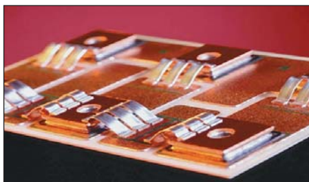
Рис. 2. Соединения в силовых приборах, выполненные с помощью ленточных перемычек
