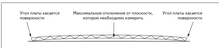
Рис. 4. Отклонение платы от плоскости по длине или ширине при деформации изгиба
