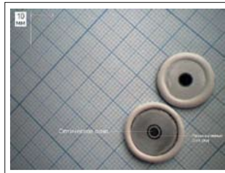
Рис. 3. Внешний вид структур фототиристоров модулей M2TOTO-80-12 и M2TOTO-80-12*
