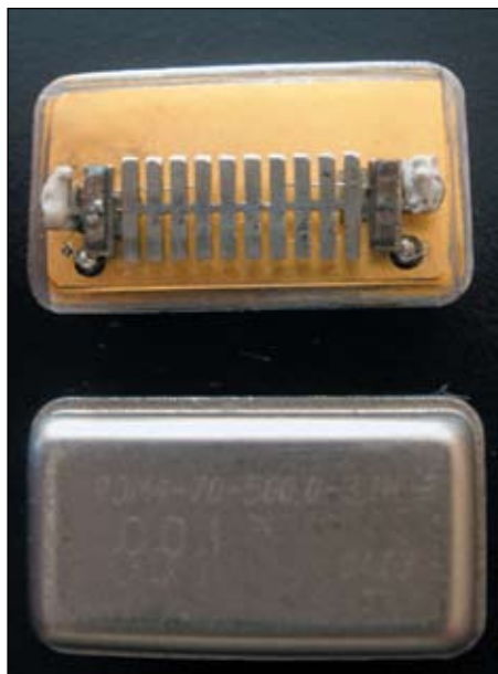
Рис. 1. Пьезомеханический фильтр с резонансной системой крутильного типа
