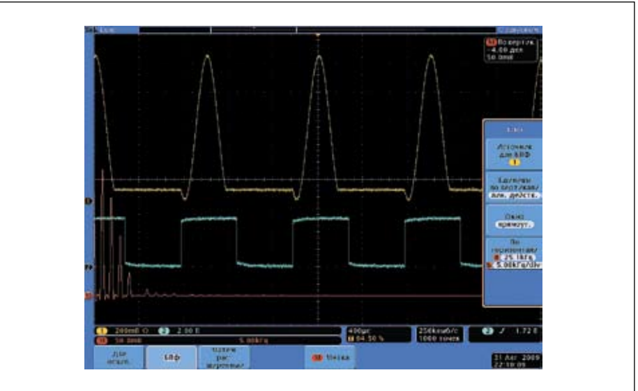
Рис. 24. Осциллограмма импульса, показанного на рис. 23, и его спектр
