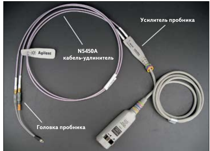
Рис. 2. Головка пробника Agilent InfiniiMax, удлинительные кабели и кабель усилителя
