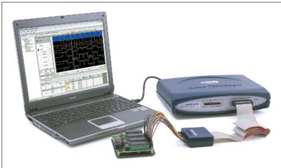
Рис. 1. Логический анализатор АКИП-9104
