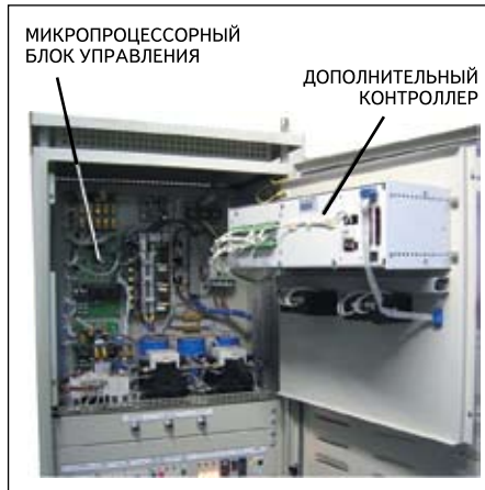
Рис. 14. Современное зарядное устройство с микропроцессорным блоком управления и дополнительным контроллером
