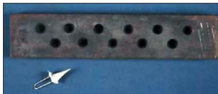
Рис. 5. Железная волочильная доска, применявшаяся в первой половине XX в. (в нижней части рисунка — силиконовый оттиск волочильного отверстия, профиль отверстия аналогичен используемому в современных фильерах)
