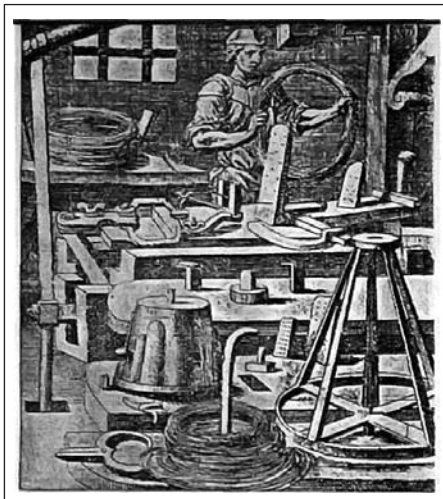
Рис. 4. Приспособления, которые использовались в XVII в. для ручного изготовления проволоки
