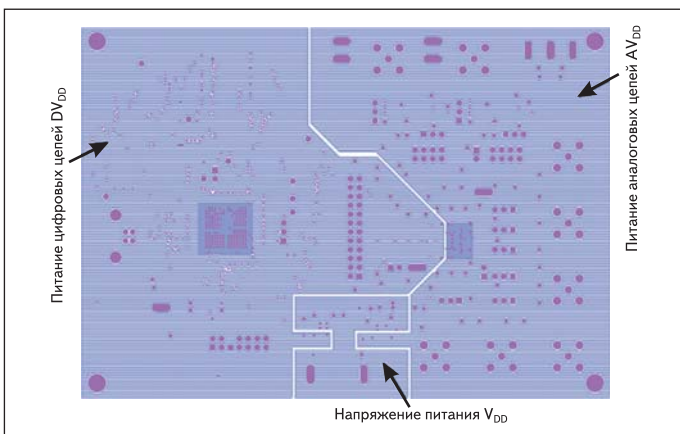
Рис. 11. Пример построения цепей питания в слое 4 печатной платы 8-канальной системы сбора данных на основе MAX11046
