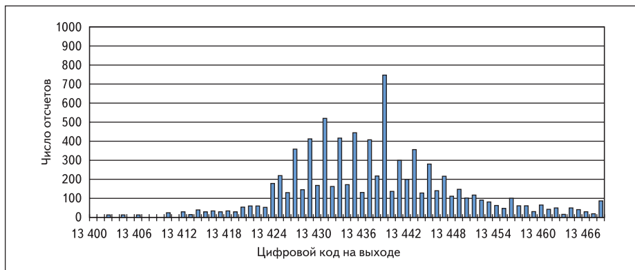
Рис. 13. Гистограмма выходного сигнала для системы сбора данных до оптимизации разводки печатной платы
