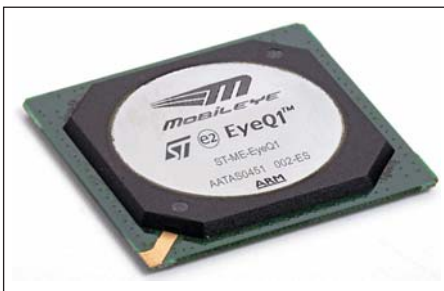
Рис. 7. Процессор обработки видеоданных для автомобильных СПВ Mobileye EyeQ первого поколения — EyeQ1
