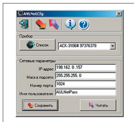
Рис. 5. Настройка сетевых параметров прибора
