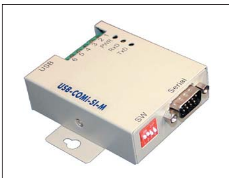
Рис. 2. Внешний вид преобразователя USB-RS422/485 с оптической развязкой USB-COMI-SI-M
