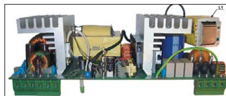
Рис. 8. Внутреннее устройство в ИВЭП с БТВ мощностью 1 кВт (стрелкой показан корректирующий дроссель L_1 )
