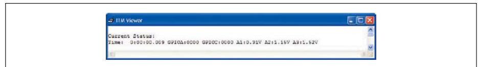
Рис. 6. Отладка "printf-style" с использованием ITM-регистров
