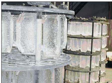
Рис. 4. Кристаллы кварца, выращенные гидротермальным методом
