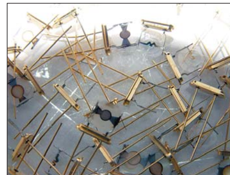
Рис. 3. Резонаторы для объемного монтажа без кожууха
