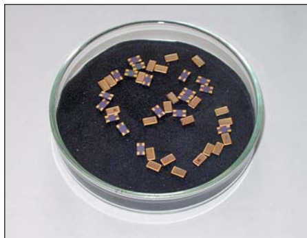
Рис. 2. Резонаторы для поверхностного монтажа
