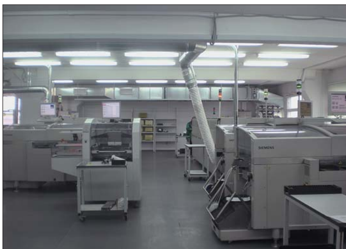
Рис. 3. Линия на базе установщиков Siplace CF и CS для монтажа мелких и средних серий
