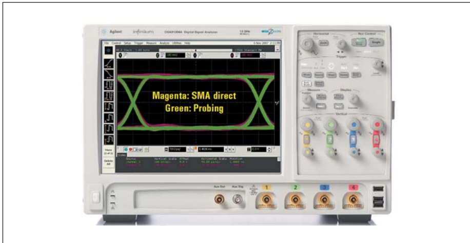
Рис. 3. Проверка характеристик системы снятия сигнала: пурпурный: прямое подключение SMA; зеленый: снятие сигнала через пробник
