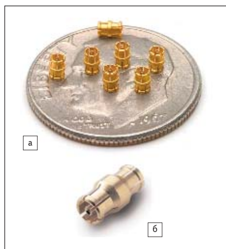
Рис. 9. Одноканальные адаптеры «розетка–розетка»: а) G3PO–G3PO на 10-центовой монете; б) GPO–GPO
