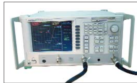
Рис. 11. Измерение коэффициента шума на векторном анализаторе цепей Anritsu MS4623B с опцией 04
