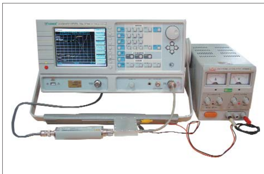
Рис. 13. Измерение КШ при помощи «СК4-БЕЛАН 32» с опциями 005 и 006
