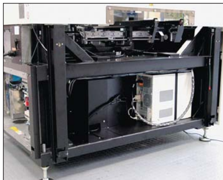
Рис. 3. Сварная виброгасящая станция
