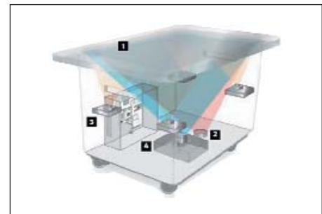
Рис. 39. Конструкция компьютерного столика Milan: 1 — крышка стола (акриловый экран для проектора); 2 — четыре инфракрасные камеры с разрешением 1280×960 пикселей; 3 — системный блок компьютера с процессором Core Duo; 4 — DLP-проектор с разрешением 1024×768 пикселей
