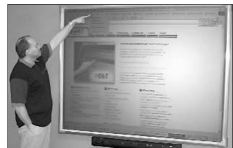
Рис. 27. 84-дюймовый сенсорный экран на базе машинного зрения (используется задняя проекция)
