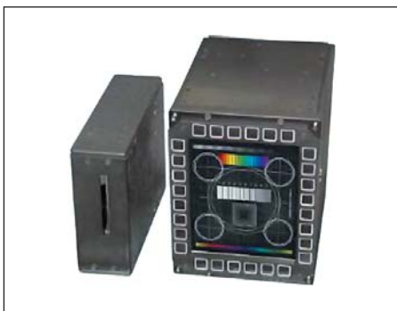
Рис. 5. Многофункциональный пульт управления для жестких условий эксплуатации (НПК «ЭЛАРА»)
