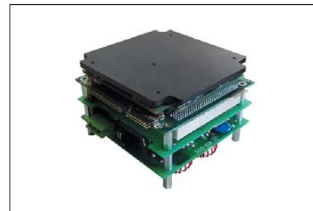
Рис. 2. Схема рассеивания тепла для систем на базе модулей PC/104
