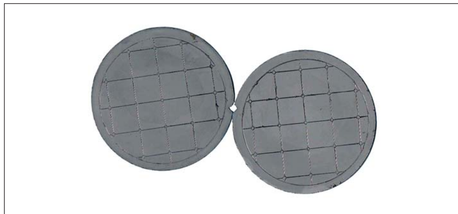
Рис. 3. Финишная сторона пластин (100) после термомиграции. Сколы на краях пластин позволяют судить об ориентации зон относительно направлений {011}
