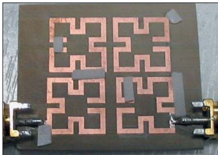
Рис. 3. ППФ на полуволновых резонаторах с перекрестной связью MFRM-01170123-01 ( f_0 = 1200 МГц, \Delta f = 60 МГц, L_0 \approx 2,5 дБ, K_{П(-20дБ)} \approx 2,5 , размер подложки 34×28 мм)
