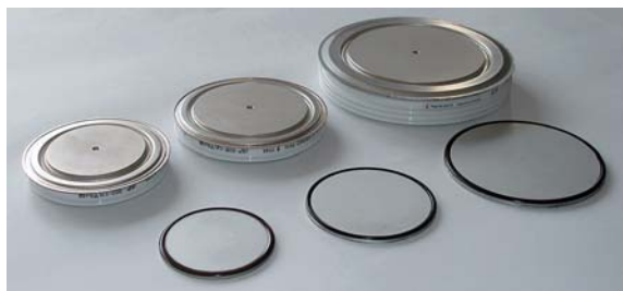
Рис. 2. Реверсивно-включаемые динисторы на импульсные токи от 250 до 500 кА и блокирующее напряжение 2400 В в герметичном металлокерамическом корпусе и в бескорпусном исполнении (размеры элементов 63, 76 и 100 мм)
