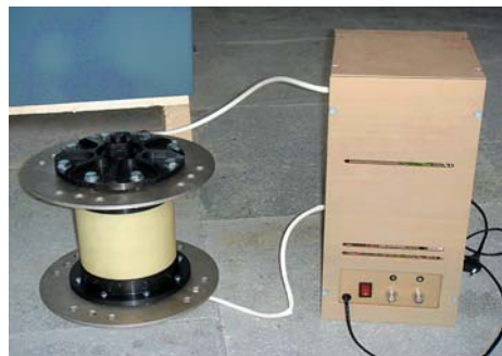
Рис. 3. РВД-коммутатор (тип ключа КРД-25-300) на рабочий ток 300 кА, напряжение 25 кВ (слева) с подключенным генератором запуска (справа)
