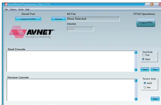
Рис. 6. Вид основного окна утилиты Avnet Programming Utility, соответствующий режиму загрузки конфигурационной последовательности в ПЛИС
