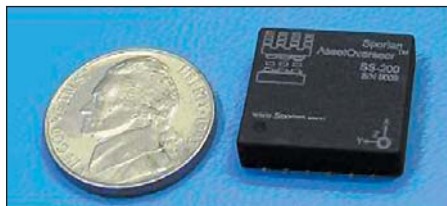
Рис. 6. Ультрамаломощные датчики удара / акселерометры AssetOverseer SS-200 ( \pm 200 g)
