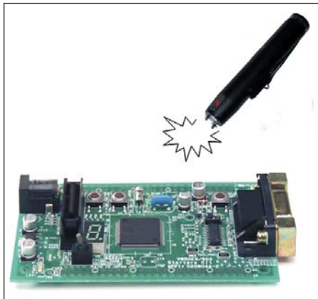
Рис. 2. Тестирование оценочной платы искровым генератором
