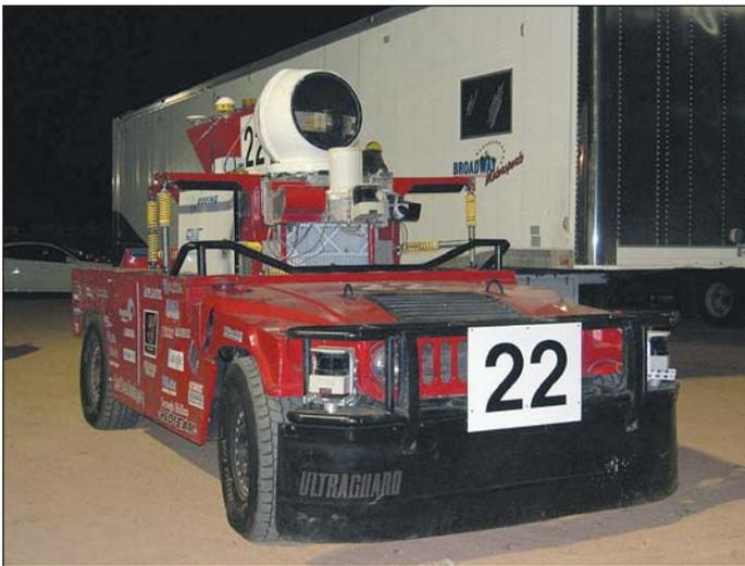
Рис. 3. Пример мобильного робота с лазерными сканерами
