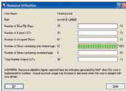
Рис. 89. Вид информационной панели, содержащей сведения о ресурсах ПЛИС, используемых для реализации компаратора floating_point_compare_cc
