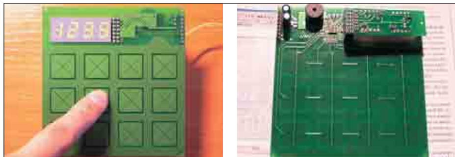
Рис. 15. Внешний вид клавиатуры с использованием технологии CapSense
