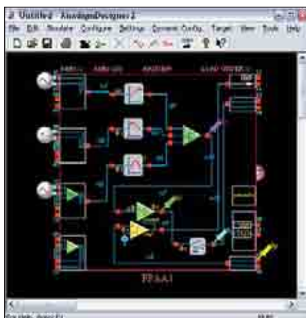
Рис. 4. Окно интерфейса программы AnadigmDesigner2 для проектирования схем на базе ПАИС
