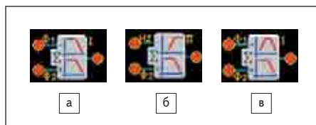
Рис. 36. Условное обозначение сумматора с биквадратичными фильтрами
