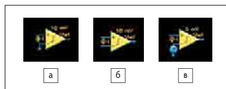
Рис. 6. Условное обозначение компаратора
